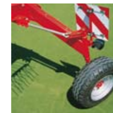
Afbeelding boven: Gestuurde heavy duty wielen 10.0/75-15.8 8 ply
