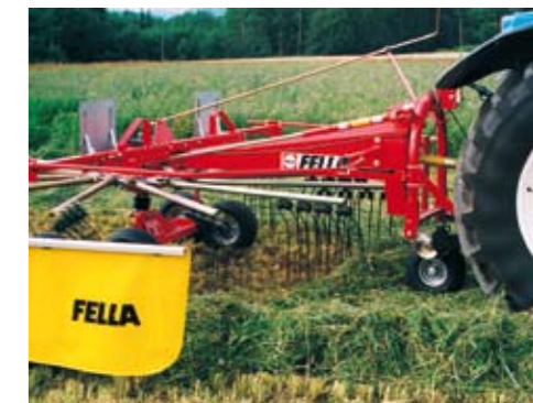
Zwaar, stabiel frame met scharnierende driepuntsbok en telescoop stang demping. Het laagliggend trekpunt betekent dat de hark op tandarm hoogte wordt getrokken. Deze constructie geeft een bijzonder rustige loop. Bij het heffen wordt de hark automatisch in het midden gecentreerd.
