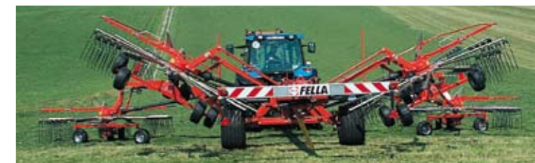
Afbeelding boven: Degelijke, overzichtelijke aandrijflijn. Iedere rotor beveiligd door middel van slipkoppeling. Grote transportbanden 500/50-17 standaard.
