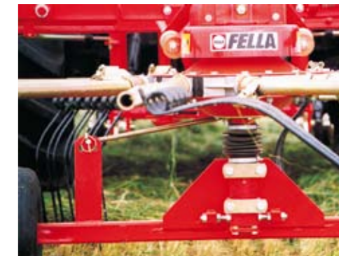
Optimalisering van het zwad door in 3 standen verstelbare curvebaan. Per draai spindel (dus niet aan de wieltjes) wordt de tandhoogte lineair afgesteld d.w.z. de schuine stand van de rotor hoeft niet te worden bijgesteld (Fella patent)
