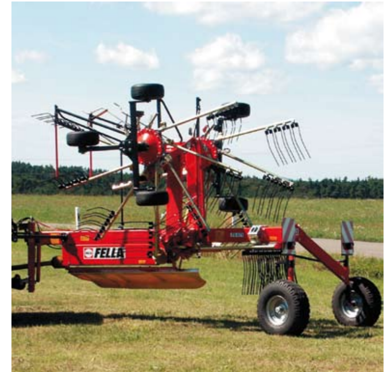
Afbeelding boven: Automatisch in- en uitklappend zwaddoek tussen de rotoren, afneembare tandarmen en wegklapbare beschermbeugel. Spoorstangen van de fuséébesturing zoals bij kleine vrachtwagens gebruikelijk is garanderen de hoogste kwaliteit tot in ieder detail.
