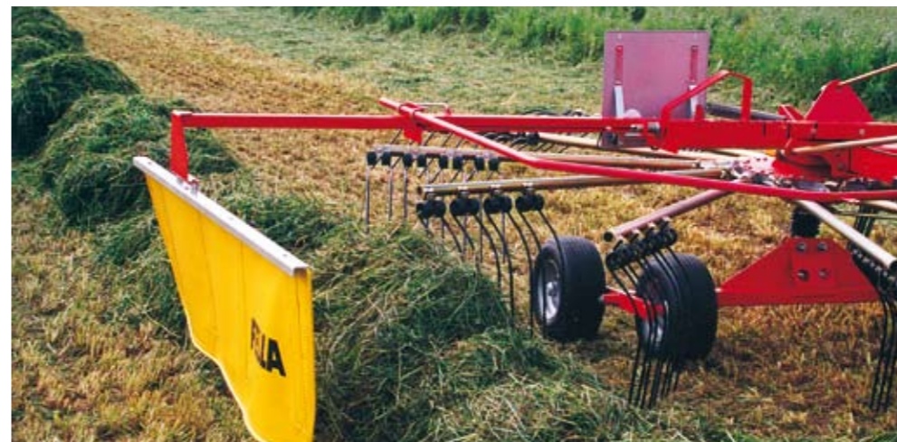
Zwaar, stabiel frame met scharnierende driepuntsbok en telescoop stang demping. Het laagliggend trekpunt betekent dat de hark op tandarm hoogte wordt getrokken. Deze constructie geeft een bijzonder rustige loop. Bij het heffen wordt de hark automatisch in het midden gecentreerd.
