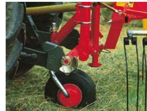
Tastwiel voor golvend terrein ter verbetering van de bodemaanpassing (accessoire).
